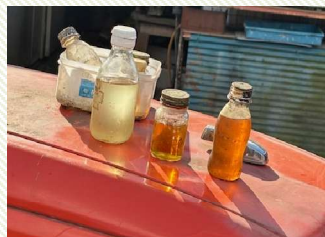
左が精製した油。右が廃油で遠心分離器にかけると燃料となります。
